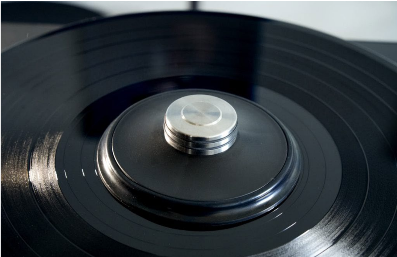
Eine richtige Gummidichtung verhindert ein Feuchtwerden des Labels. Die Verschraubung ist dank umlaufender Gummis griffig (Foto: R. Vogt)
